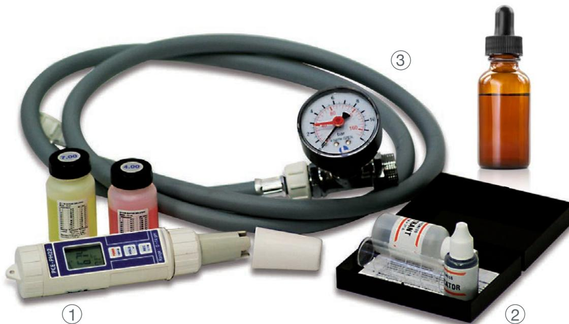
Misurazione e controllo della pressione dinamica, della durezza acqua in entrata, del pH di lavaggio/risciacquo e verifica con reagente su eventuali residui di detergente
